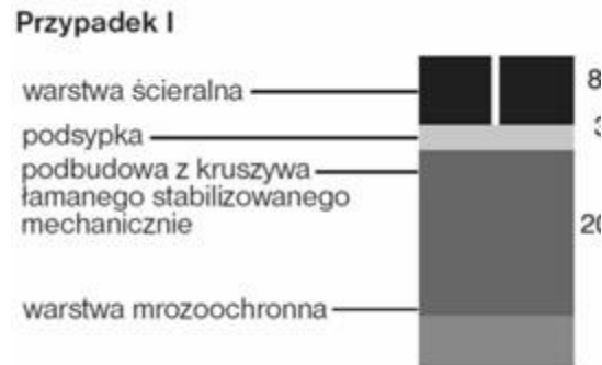
2.4. Konstrukcja nawierzchni dla kategorii ruchu R_3 – grubość warstwy w [cm]
