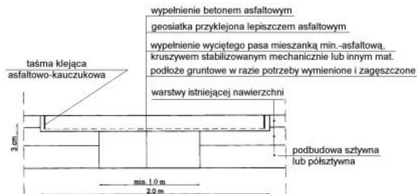
Rys. 4. Naprawa głęboka pojedynczego pęknięcia odbitego, w przypadku braku dobrego podparcia krawędzi pęknięcia, z ułożeniem nowej warstwy asfaltowej
